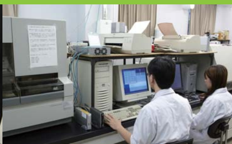
ジェネティックアナライザー DNAサンプルの塩基配列を読みとる装置。
