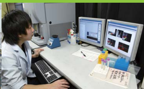
細胞分取分析装置(フローサイトメーター) 細胞のみを選び分けて集めることができます。
