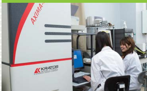
レーザーイオン化飛行時間型質量分析装置 低分子や高分子量の質量(分子量)を測るための装置。
